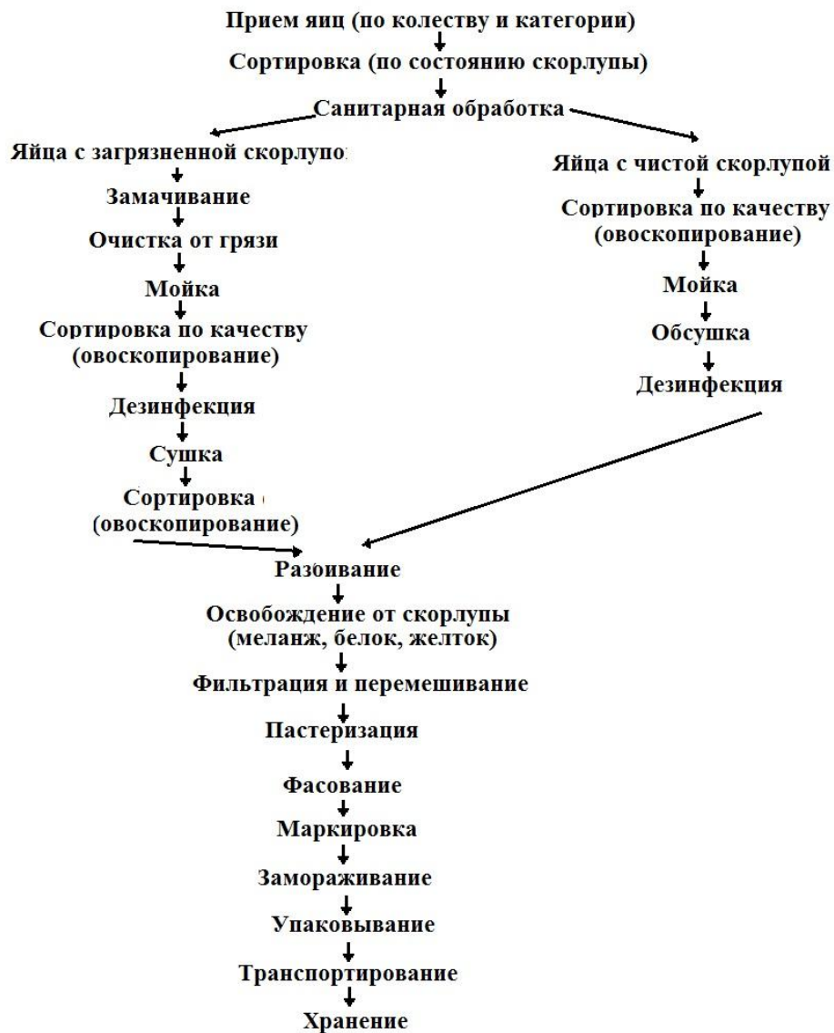
Рис. 1.1. Технологическая схема изготовления яичных мороженых продуктов
